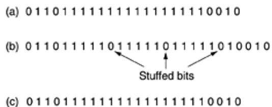
Figura 3.5: Inserção de bits. (a) Os dados originais. (b) Como os dados são exibidos na linha. (c) Como os dados são armazenados na memória do receptor após a remoção de bits
