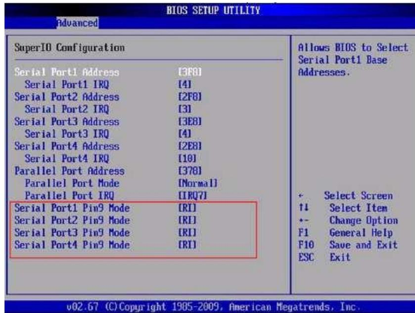
Nesse menu pode ser configurada a alimentação da porta serial. Normalmente essa opção é utilizada para alimentar um leitor de código de barras (Opção 5V) ou alimentar o display de cliente (opção 12V). Pressione a tecla [ENTER] sobre a porta serial selecionada para abrir o painel de opções.
