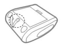
O compartimento do acessório se encontra embaixo da borracha central na parte inferior da impressora, conforme sinalizado na imagem ao lado.
