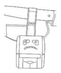
Abra o velcro da tira de couro, posicione e encaixe-a na posição desejada. Você pode utilizar sua impressora normalmente.
