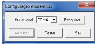
Clique em **“Testar”**, para efetuar teste de comunicação com o modem.
