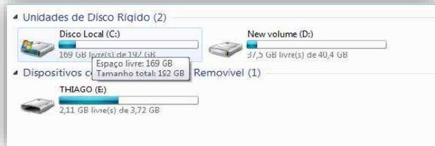
2º Questione o cliente qual é a partição em que foi instalado o sistema operacional, caso o cliente não possua partições na maquina instale na C:
