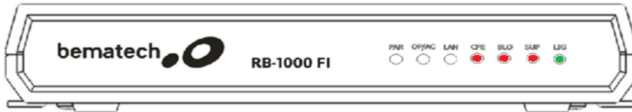
LED LIG + (SUP, BLO, CFE): A combinação destes Led's ligados indicam a necessidade de suporte ao equipamento. Haverá então a necessidade de direcionar o cliente através de indicações para Assistências Técnicas onde o mesmo receberá maiores esclarecimentos.
