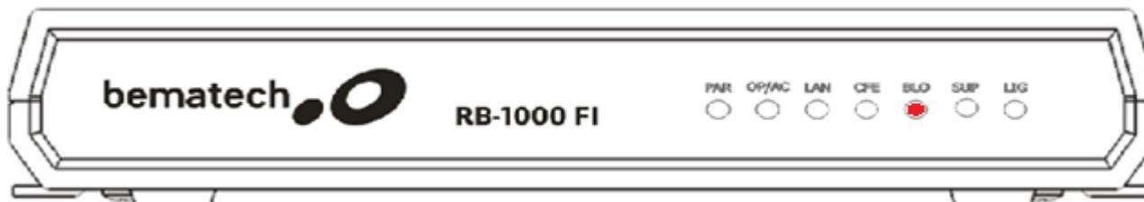
**BLO:** O terceiro led “BLO” quando aceso informa que houve bloqueio pela SEFAZ, Contribuinte ou devido a problemas técnicos no equipamento. Se este led alternar entre aceso e apagado, o aparelho sofreu um bloqueio autônomo.
