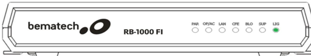
LIG: O primeiro led “LIG”, deverá estar ligado, com a indicação de que o aparelho esta funcionando. Em casos em que o aparelho apresentar o led apagado, deverão ser verificados conexões, cabos e portas de comunicação afim de correção de possíveis erros de instalação de equipamentos.
