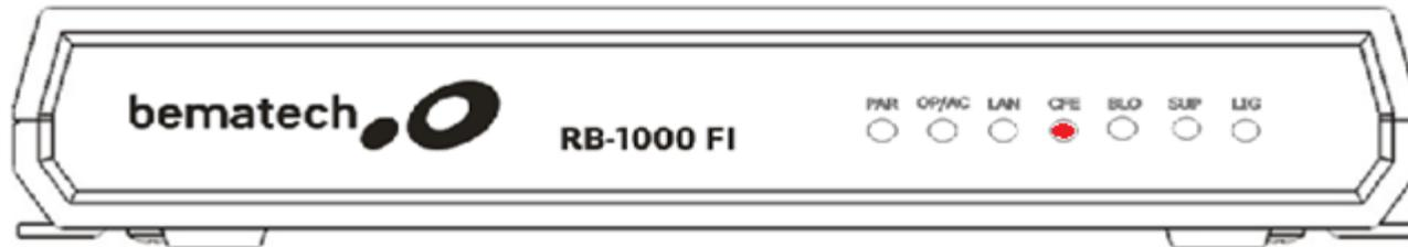
CFE: O quarto led “CFE” indica que existem documentos pendentes de transmissão para o SEFAZ. Caso este led esteja piscando o equipamento SAT esta tentando transmitir informações e/ou documentos para o SEFAZ. Esle led apagado significa que o equipamento esta funcionando normalmente e sem transmissões pendentes.
