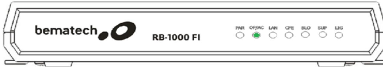
OP/AC: O sexto led "OP/AC indica que o equipamento esta pronto para se comunicar com a Aplicação Comercial. Se este led alternar entre aceso e apagado o equipamento SAT já esta se comunicando com a Aplicação Comercial. Se o led permanecer apagado, o equipamento RB-1000 ainda não esta preparado para se comunicar com a Aplicação Comercial, será necessário rever as configurações de instalação do aparelho e solicitar ao cliente que confirme a compatibilidade da aplicação Comercial com o RB-1000.
